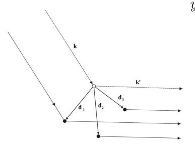
$$y = e^{i (\vec{k'} \cdot \vec{r} - \omega t) + i \vec{K} \cdot \vec{d_1}} + e^{i (\vec{k'} \cdot \vec{r} - \omega t) + i \vec{K} \cdot \vec{d_2}} + e^{i (\vec{k'} \cdot \vec{r} - \omega t) + i \vec{K} \cdot \vec{d_3}}$$
